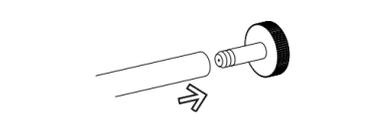
3. Branchez l'autre extrémité du tuyau au manche aspirateur. Placez la pointe en diamant adaptée dans le manche. Il existe neuf types de pointes en diamant.
